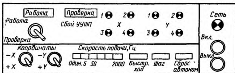
Рис. 6.10. Пульт контроля устройства управления шаговыми приводами
