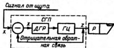
Рис. 2.6. Структурная схема следящего гидропривода:
